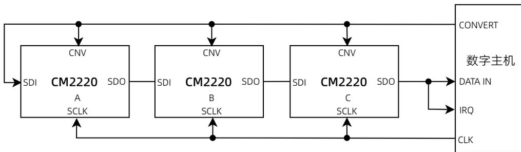
图 24 有繁忙指示连接图 (级联模式)
