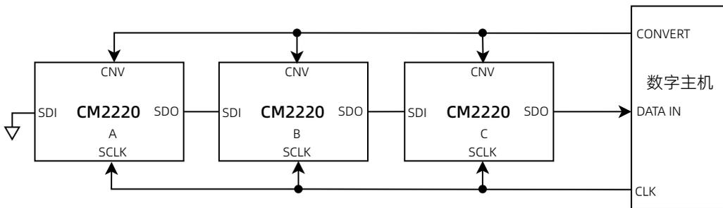
图 23 无繁忙指示连接图 (级联模式)
