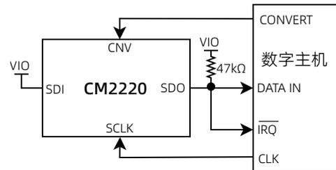
图 20 三线串口有繁忙指示连接图（片选模式）
