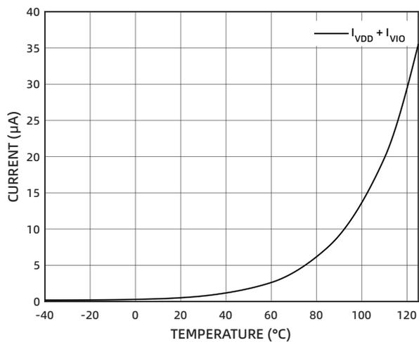
图 13 待机电流的温度特性
