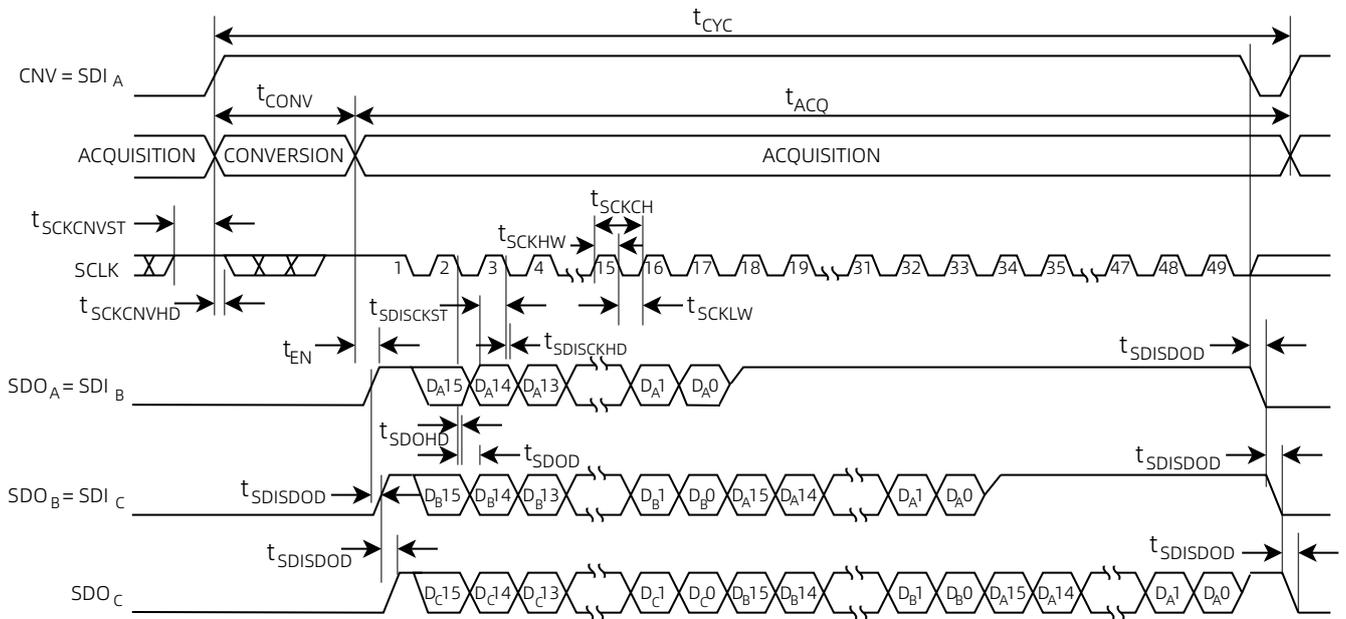
图 6 有繁忙指示串行接口时序（级联模式）
