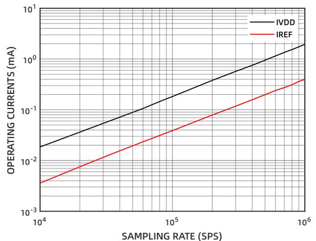
图 18 工作电流随采样率的变化
