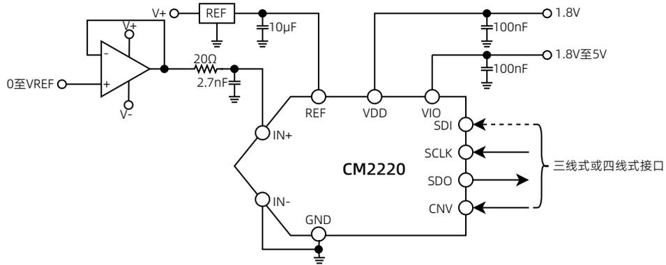
图 25 采用多个电源的典型应用电路
